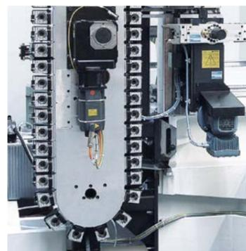
**Variabel: Scheibenmagazin mit zwei unabhängigen Magazinscheiben ermöglicht eine extrem schnelle Bereitstellung von bis zu 120 Werkzeugen.**
